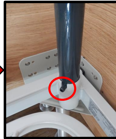
Darauf achten dass die Nase in die Aussparung einrastet
